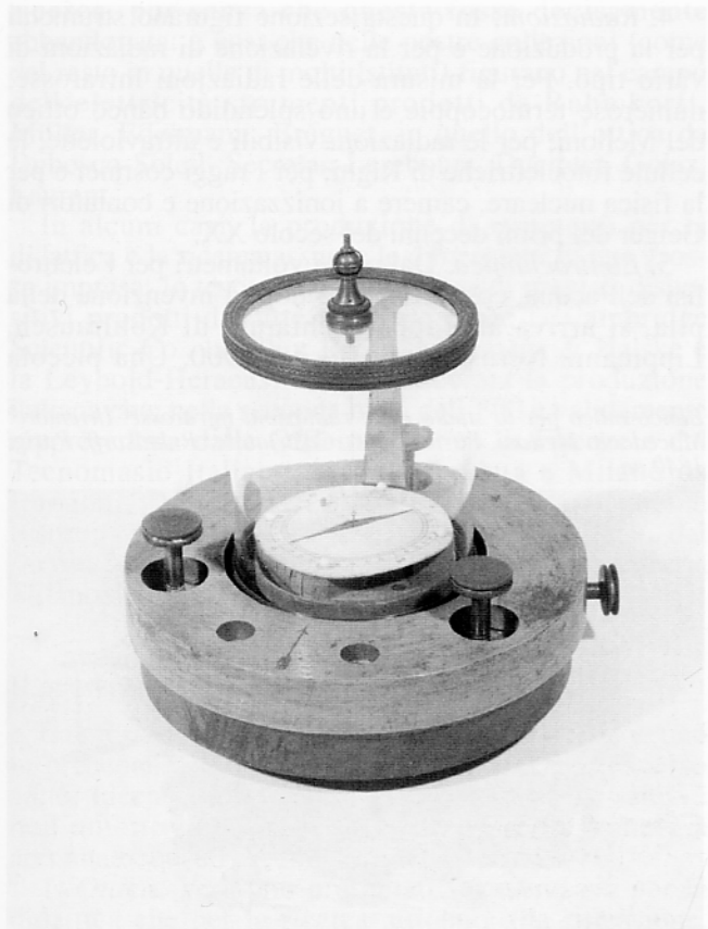
Galvanometro astatico. Inventore e costruttore: Leopoldo Nobili, Reggio Emilia 1830.
